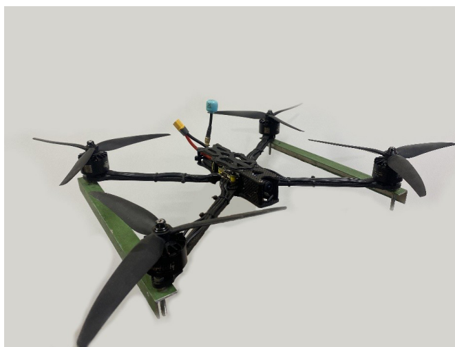
Рис. 5. Разработанный авторами БПЛА FPV-типа
